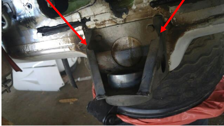
תומך חיבור תחתון של כן הנסע לגוף המטוס מכופף – מבט מתא המנוע לקיר האש
