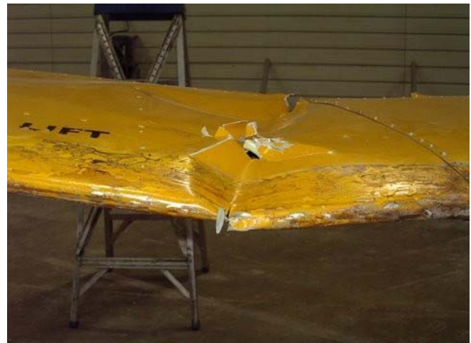
Un stabilisateur de droite endommagé
